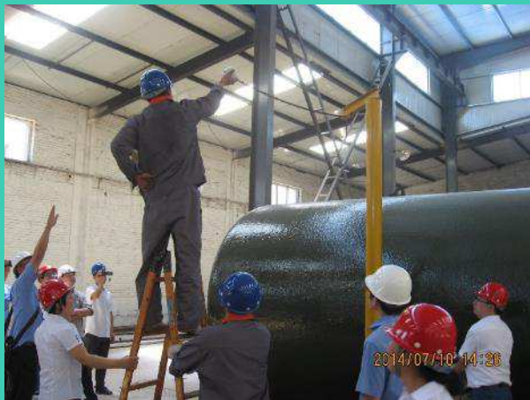
罐体冲击检测
